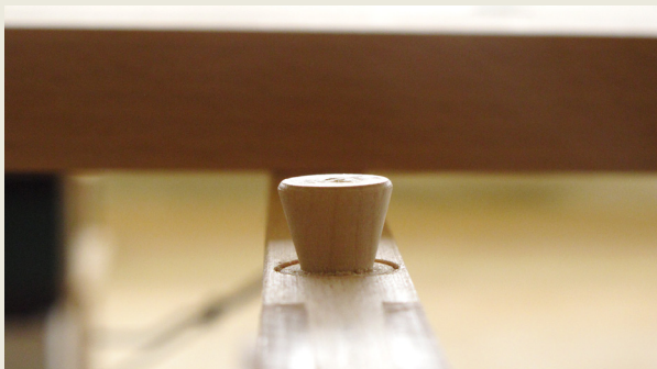
Detail: runder Schwalbenschwanzzinke
